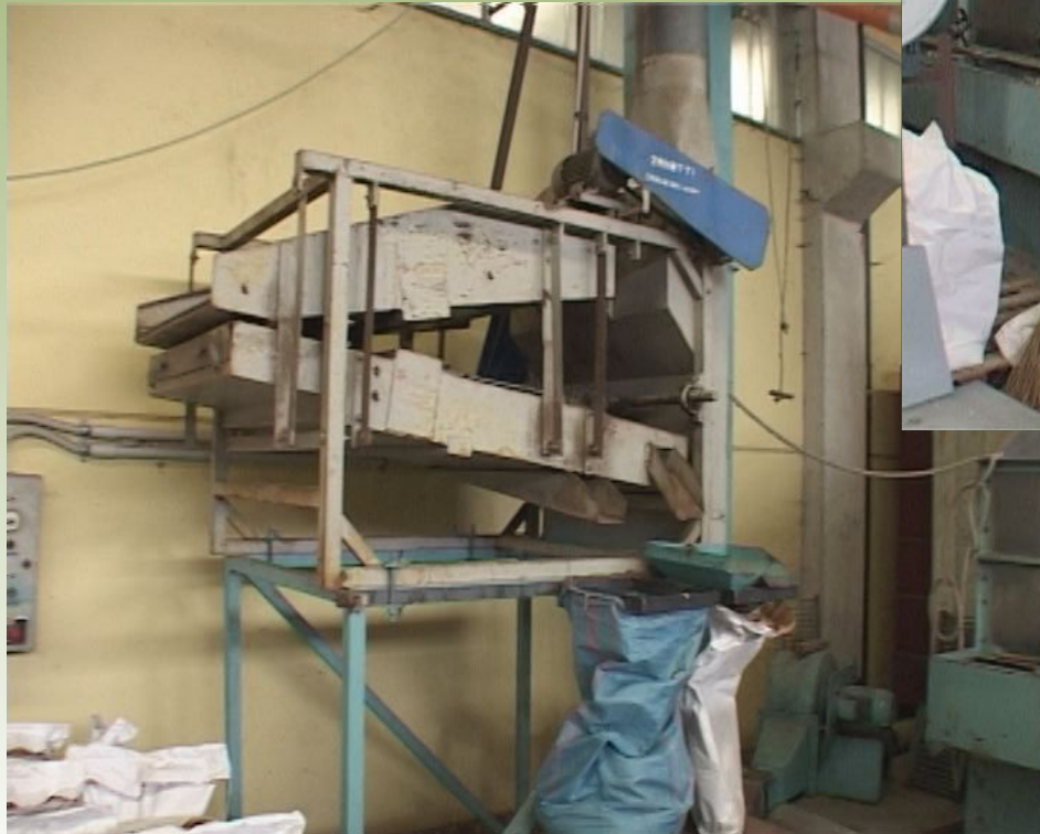
Impianto di selezione a setaccio con fori calibrati e ventilatore
